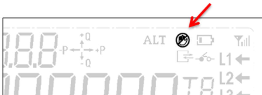
Рисунок 14 – Отображение включения режима программно-аппаратной блокировки переключения реле
