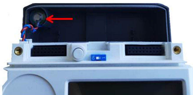
Рисунок 22 - Место установки дополнительной батареи RTC в счетчике исполнения «Х»
