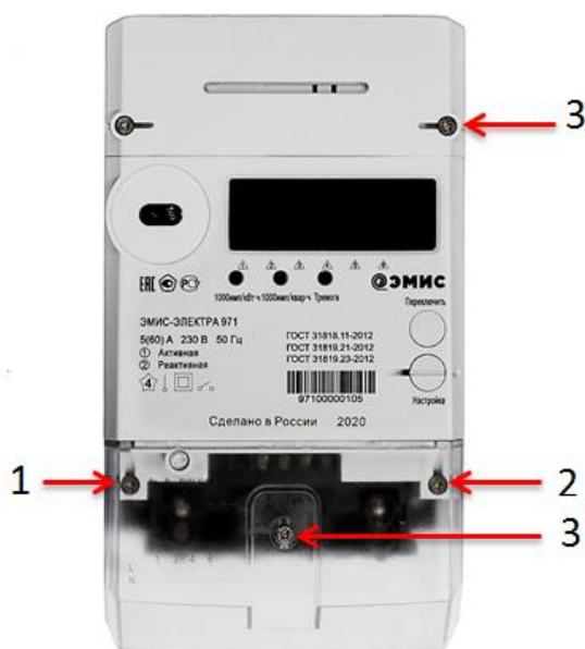
Рисунок 45. Места установки контрольных пломб счетчика исполнения «Х»
