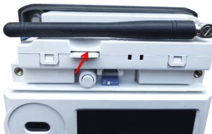
Рисунок 18- Установка SIM-карты в слот БВПД модели ЭС-770-12-G счетчика исполнения «Х»
