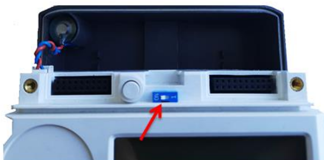
Рисунок 21 - Переключатель аппаратной фиксации реле счетчика исполнения «Х»
