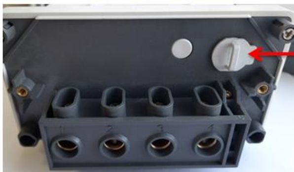
Рисунок 23 - Место установки дополнительной батареи RTC в счетчике исполнения «С»
