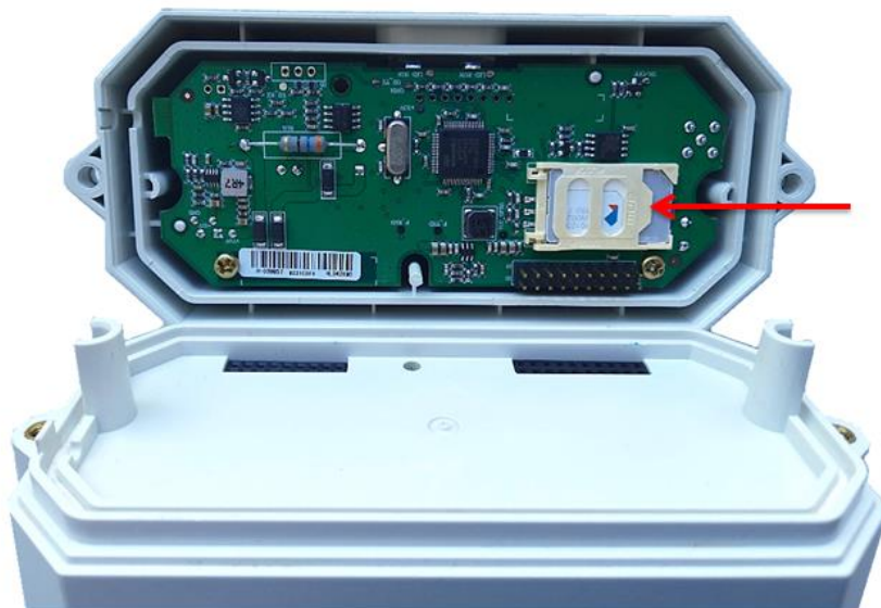
Рисунок 19 - Установка SIM-карты в слот БВПД модели ЭС-770-13-G счетчика исполнения «С»
